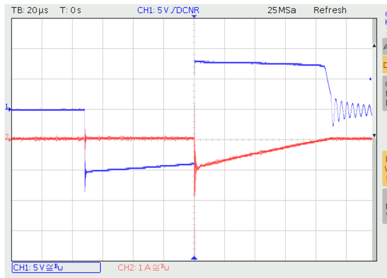
Осциллограмма 4. Напряжение (синий) и ток (красный) во вторичной обмотке при напряжении питания 5 вольт
